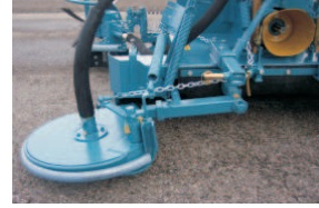
Aufhängung Schwenscheibe mit Bewegungsspielraum in alle drei Raumrichtungen
