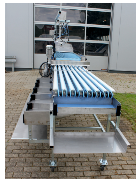
Variable Sortierfächer; Breite individuell einstellbar
