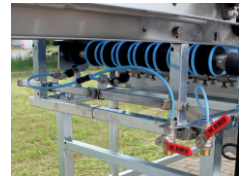
Wasserdüsen manuell einstellbar
