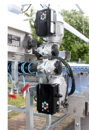
Elektro-Antriebe mit Frequenzregler (stufenlose Geschwindigkeitsregelung)
